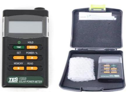
شكل (٢١) جهاز قياس شدة الاشعاع الشمسي المستخدم في التجربة
