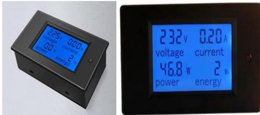
شكل (٢٣) جهاز قياس فرق الجهد والتيار (Multi meter)
