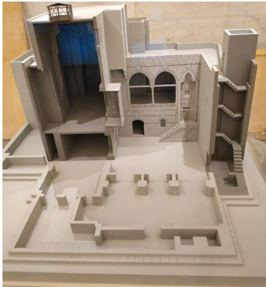
شكل (21) نموذج مجسم بيت زينب خاتون ويظهر في الصورة على اليسار القاعة بعناصرها المعمارية "الملقف، الشخشيخة، المشربية" والفناء الداخلي والمقعد والسلم المؤدي اليه، والسلم الرئيسي بين الأدوار. كما يظهر في الصورة على اليمين الواجهة الرئيسية بفتحاتها الضيقة والمحدودة والمدخل الرئيسي للبيت. المصدر: الباحث
