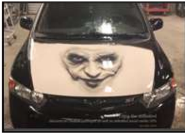
شكل (47) تطبيق دهانات الكروموضئية على السيارات وعند تعرضها للحرارة تظهر الصور والرسومات وعند إطفائها تختفي الصور والرسومات. المصدر: [29]
