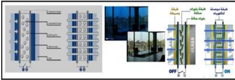
شكل (25) آلية حركة البلورات الذكية والإستجابة لشحنة الكهرباء وكيفية مرور الضوء وظهور الشفافية والإعتام في الخامة المصدر: [19،ص5]
