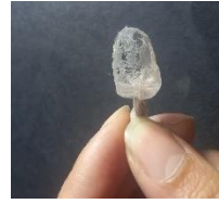
الشكل (41) تأثير الحرق على الأنسجة الخفيفة من قماش الأورجانزا حيث تعرضت الوحدة للتلف عند زيادة كثافة الثقوب
