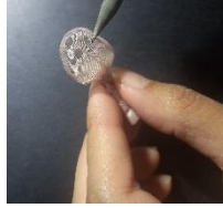
الشكل (42) تأثير الحرق على الأنسجة ذات الوزن المرتفع وعدم تأثر الأنسجة عند عمل ثقوب متقاربة
