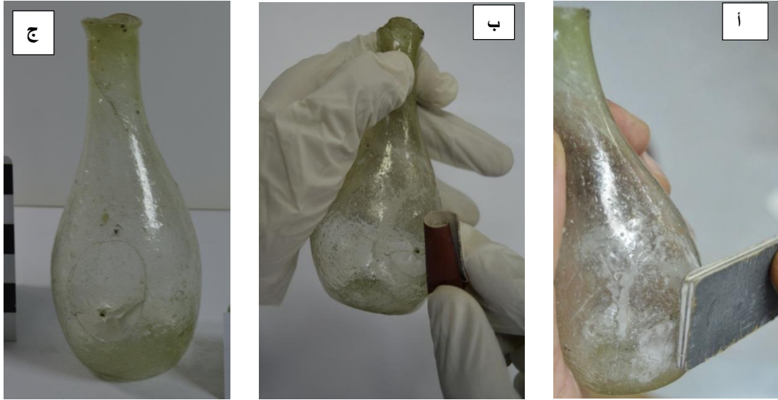
لوحة رقم (5) توضح تثبيت الجزء المكمل للجزء المفقود صور رقم (أ)، (ب) توضح عملية الصقل والتسوية للجزء المستكمل باستخدام ورق الصنفرة الناعمة جدا بعد تثبيته بلاصق الأراالديت وتركه فترة لتمام تصلبه صورة رقم (ج) توضح الجزء المستكمل بعد الانتهاء من عمله
