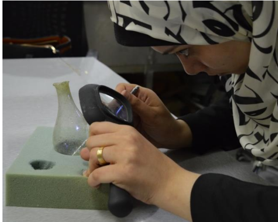
صورة رقم (8) توضح القيام بعملية التنظيف الميكانيكي باستخدام مشرط ذو سن دقيق وذلك تحت عدسة مكبرة مراعاة لعدم خدش الزجاج.
