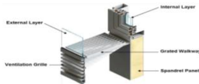
شكل (4): يوضح الطبقتين الداخلية والخارجية للواجهة المزدوجة (6)
