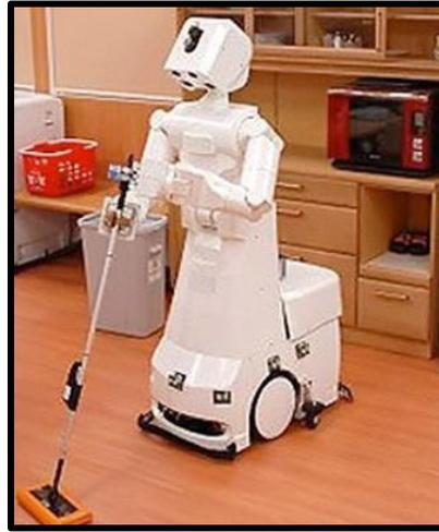
شكل (9) يوضح مكنسه كهربائيه تعمل بتقنية الذكاء الاصطناعي
