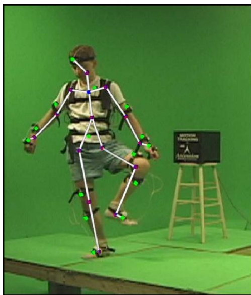
صورة (١٥) توضح لاقط الحركة المغناطيسي.
