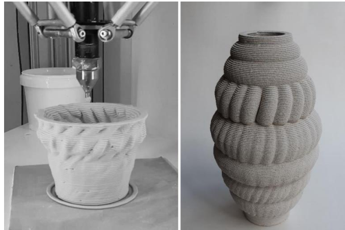
شكل 6 الطباعة ثلاثية الأبعاد للشكل الخزفي المنفذ في البيئة الافتراضية
