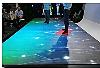
صورة رقم (7) توضح استخدام شاشة العرض LED في الأرضية وهي نوع من شاشات العرض LED المصممة خصيصاً للعرض الأرضي
