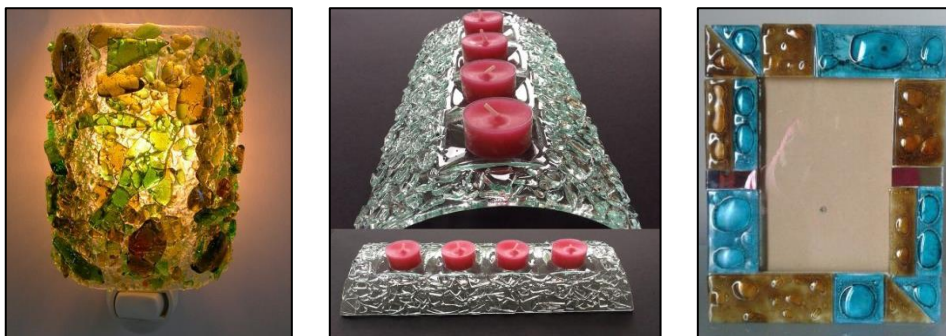
شكل رقم (٣) بعض المنتجات الزجاجية المنفذة من إعادة تدوير فاقد الزجاج المسطح (الكسر الزجاجي) باستخدام تقنية إعادة تشكيل الزجاج حرارياً.
