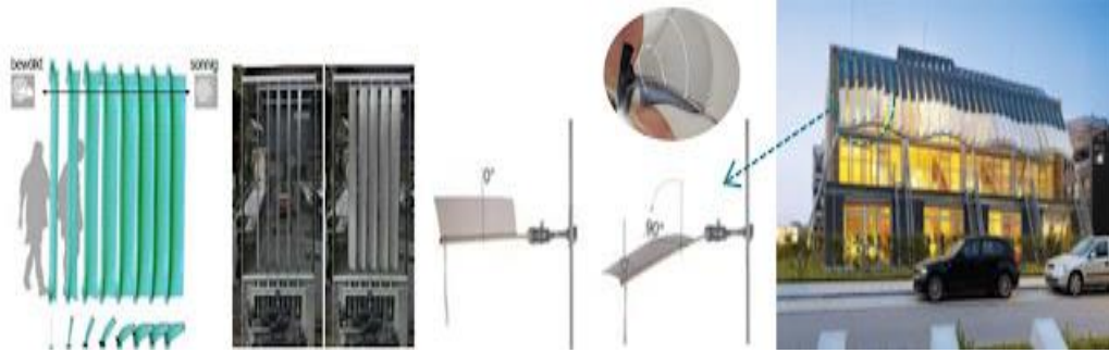
شكل (13) نظام Flectofin المشتق من حركة النبات (بلوح واحد)
