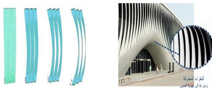
شكل (23) مثال يوضح دور الأنظمة الحركية في التهوية الطبيعية
