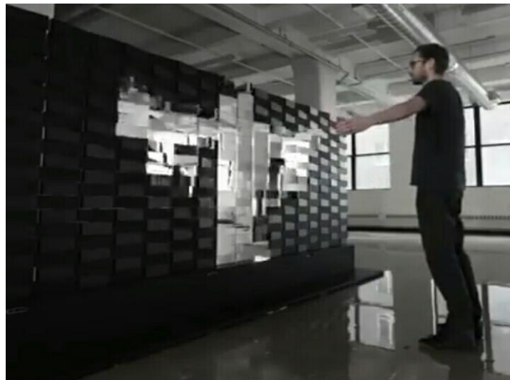
شكل رقم (18) يوضح فكرة عمل الحساس المتأثر بحركة الشخص المقابل للفاصل المعدني
