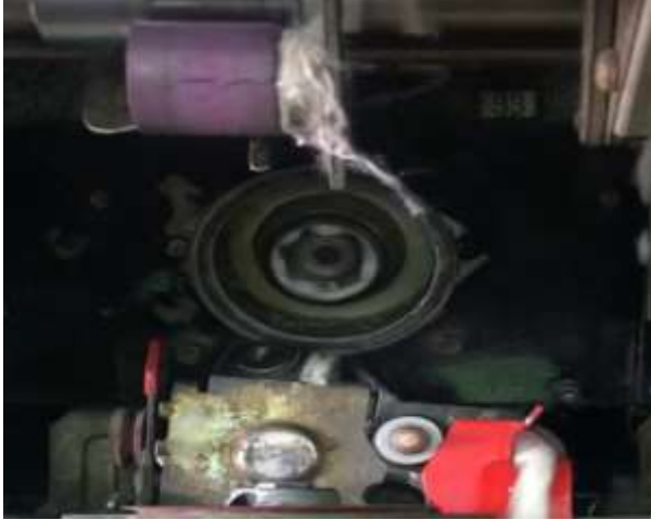
شكل رقم (7) يوضح شكل الشعيرات عند تكثيفها داخل الروتور (8)، (10)
