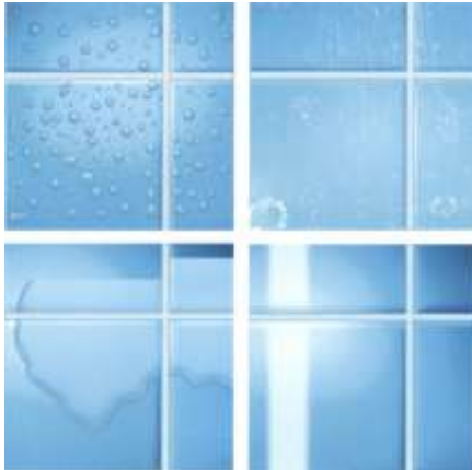
شكل رقم (12) يوضح الزجاج قبل وبعد تنفيذ تقنية النانو عليه
