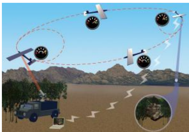
صورة (7) لنقل الطاقة باستخدام حزم الليزر
