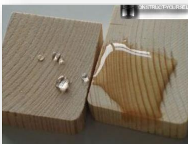
صورة رقم 4 توضح فاعلية الخشب المدهون بالطلاءات العازلة للماء (مرجع 20)
