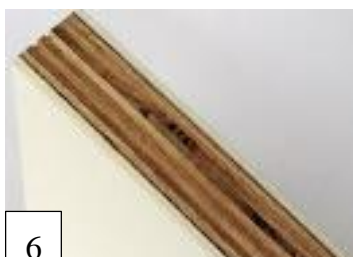
شكل رقم (7) يوضح الأنواع المختلفة للنواة الأساسية لألواح الساندوتش (1 مواد رغوية - 2 فوم - 3 صفائح مموجة - 4 خلية نحل هانى كومب) ورقية - 5 خلية نحل هانى كومب) من الألومنيوم - 6 الخشب
