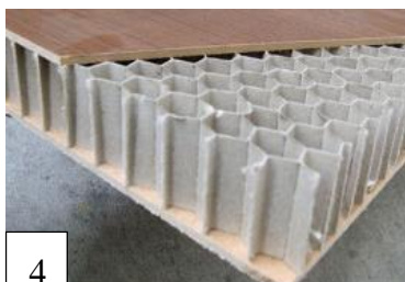
شكل رقم (7) يوضح الأنواع المختلفة للنواة الأساسية لألواح الساندوتش (1 مواد رغوية - 2 فوم - 3 صفائح مموجة - 4 خلية نحل هانى كومب) ورقية - 5 خلية نحل هانى كومب) من الألومنيوم - 6 الخشب
