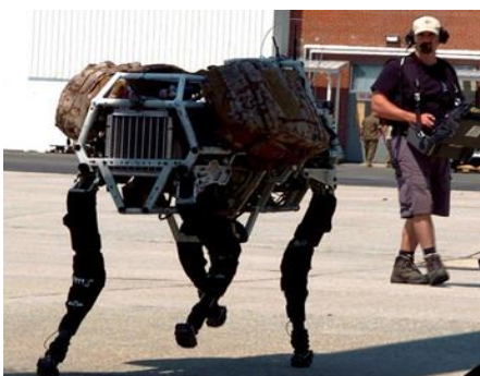
شكل (25) يوضح الروبوت BigDogs الذي طوره الجيش الأمريكي
