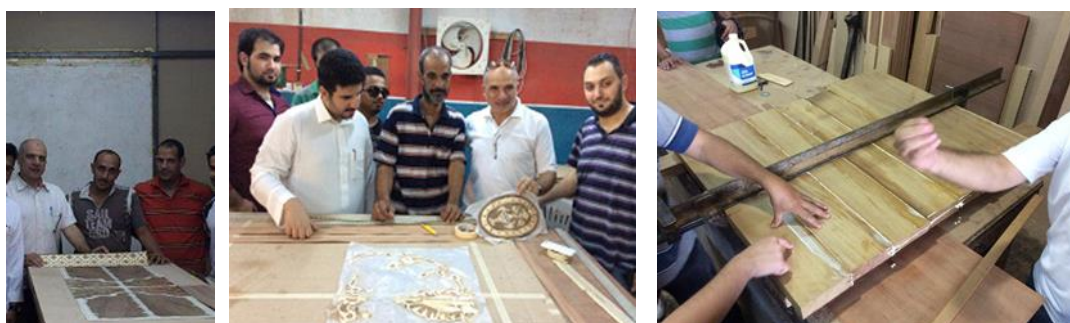
(شكل 15) يوضح قسم الكبس والتجميع ومرور الطلاب على بعض عمليات تجميع المسطحات وطريقة الكبس الهيدروليكي لمسطحات القشرة
