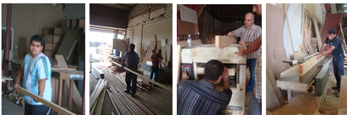
(شكل 18) يوضح مشاركة الطلاب في مرحلة المسح على ماكينة الرابوه والتخانة ثم الشق
