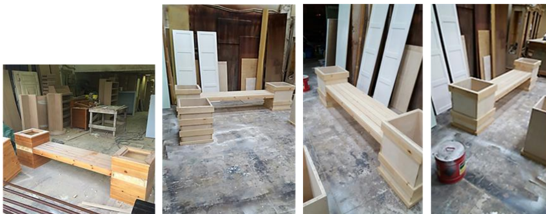
(شكل 21) يوضح مراحل التجميع لوحات المشروع داخل ورشة التصنيع
